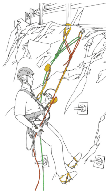
2 Systemredundanz bedeutet: voneinander unabhängiges Arbeits- und Sicherungsseil mit separater Verankerung.
