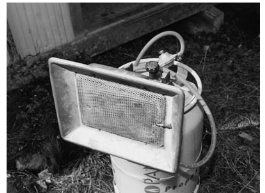
Bild 4: Gasflasche, wie sie zum Heizen und Kochen verwendet wird. Die Dichtigkeit der Gasleitungen ist regelmässig zu überprüfen, besonders nach dem Winter.
